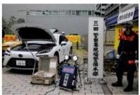
大規模災害時に停電した時に当社の社用車 MIRAIやプリウスから電気を供給します
