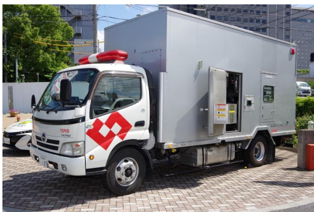
高圧発電機車（東京電力パワーグリッド株式会社）
